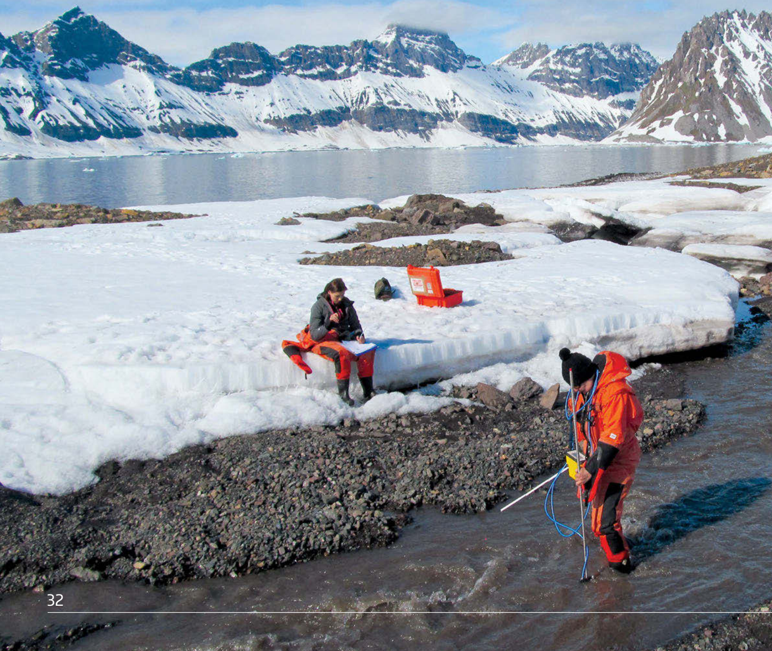
Pomiar przepływu wody w rzece Lorschelva Measurements of water outflow in the Lorschelva river
